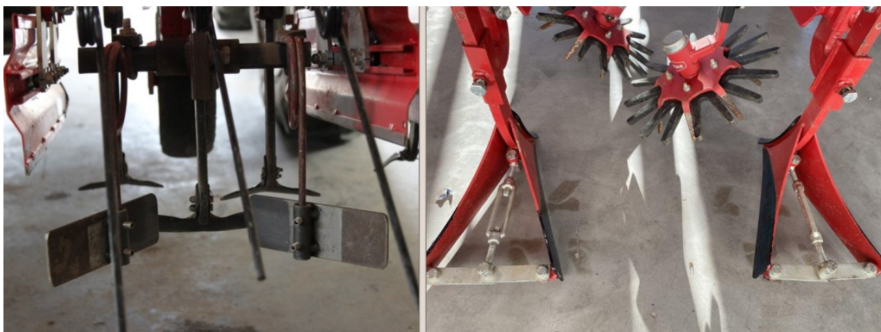
Foto 2. I GUDP-projekt blev metoder til hypning af sukkerroer sammenlignet. Den simpleste metode bestod af to metalplader monteret skråtstillet på strigletand (t.v.). En mere avanceret variant består af en kombination af fingerrensere og hyppeplove, som her er monteret på en Steketee-radrensere.
