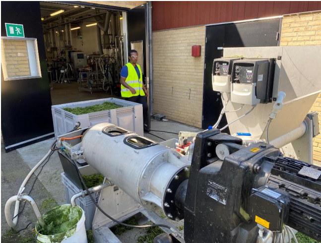
I pilotanlæg testes forskellige separeringsmetoder for at klarlægge hvilke instrumenter og parametre, der giver det højeste proteinudbytte og den bedste kvalitet.
