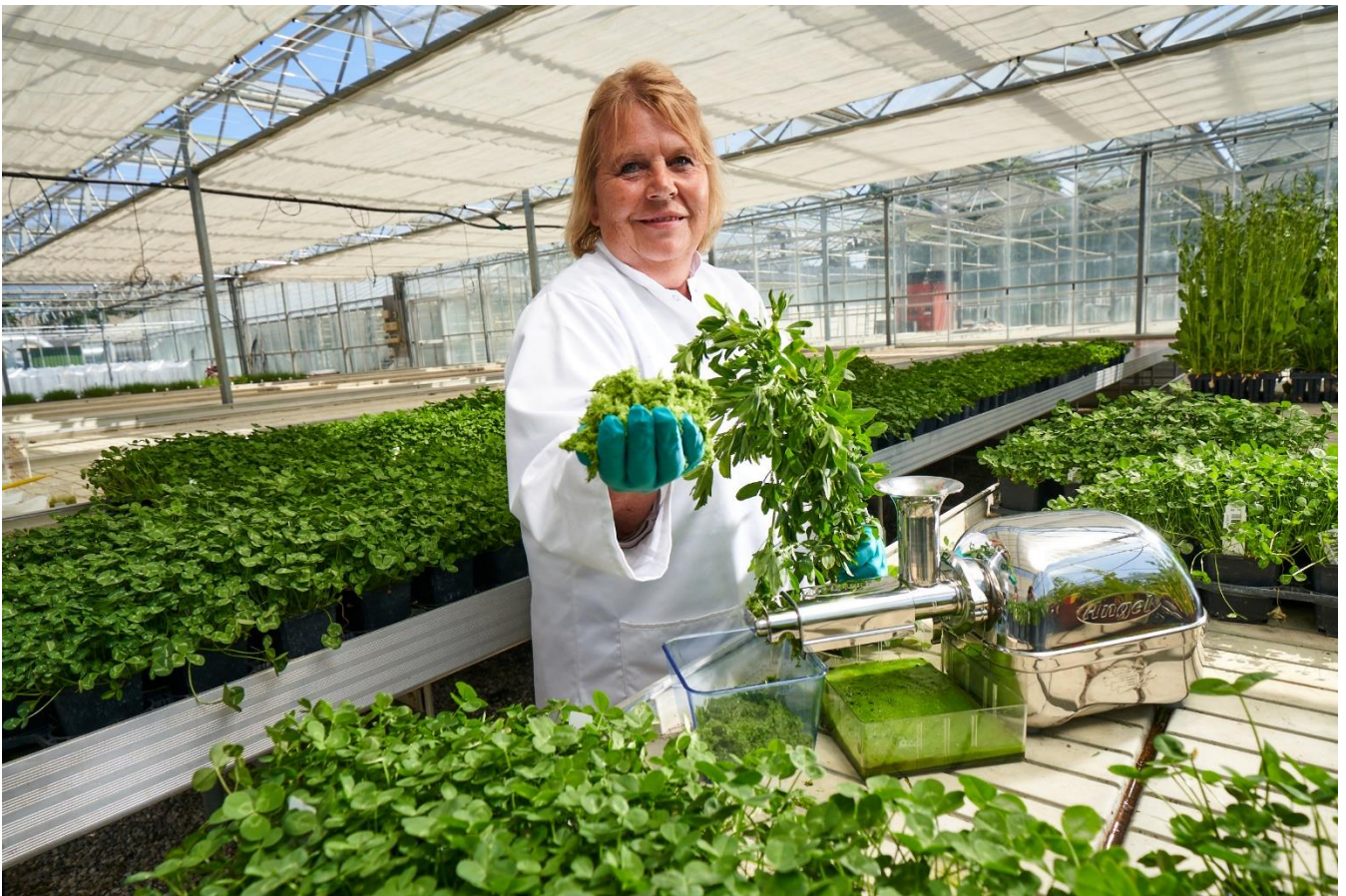
Forskellige lucernesorter bliver kørt gennem en laboratorie-juicer, der fraktionerer planten i en proteinjuice og græspulp. For at udskille protein fra juicen opvarmes denne til 80 °C og centrifugeres. Derved får man en proteinpasta, som efter tørring bliver til proteingranulat.
